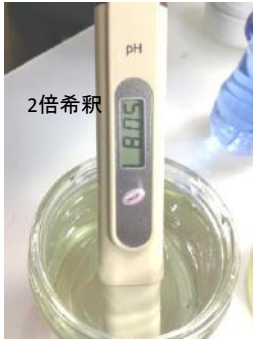
②廃棄する色に変化した2倍希釈液の酵素のPHを計測:8.05
