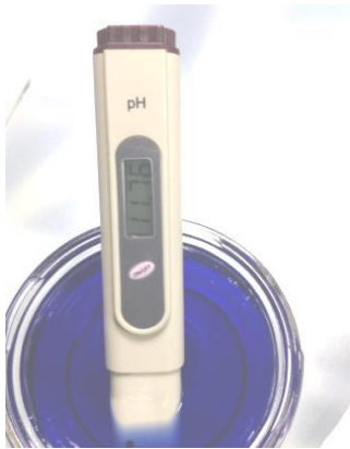
2倍希釈液の酵素のPHを計測: 11.76
