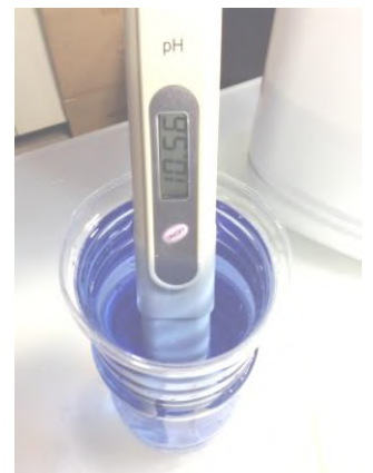
30倍希釈液の酵素のPHを計測: 10.56
