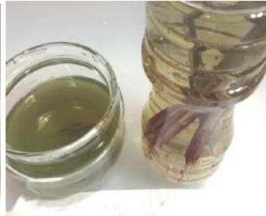
再度廃棄する色に変化した30倍希釈液で洗浄を行い酵素のPHを計測:7.93
