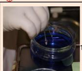
①バーを入れた 専用容器に蓋をして 超音波洗浄機で洗浄
